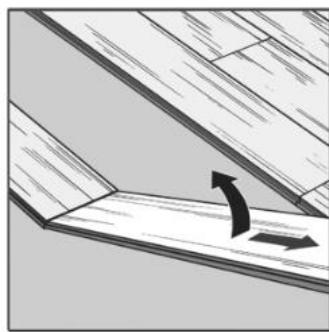
Po pokladke je možná výmena, demontáž panelov zdvihnutím, zaklonením prvého radu na dlhej strane, pre oddelenie panelov od predchádzajúceho radu. Následne sa môže oddeliť panel na krátkej strane zdvihnutím, zaklonením panelu. Prosíme, aby ste pritom postupovali veľmi opatrene, v záujme predchádzania prípadným poškodeniam klikového systému.
