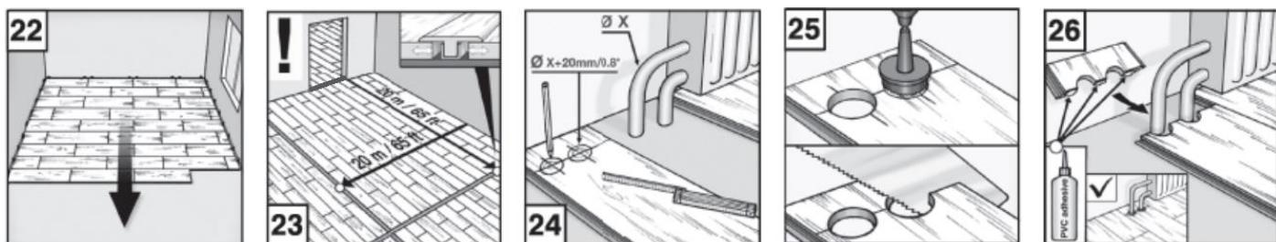
Pri radiátorovom potrubí je potrebné najprv vyznačiť miesta vývrtov, následne ich treba vyvŕtať alebo vyrezáť. Vytvorený vývrt má mať o 20 mm väčší priemer, ako je samotné potrubie. Po odrezaní je potrebné kusy panelov spojiť lepidlom. Na zakrytie medzier okolo potrubí je potrebné použiť radiátorové rozety.
