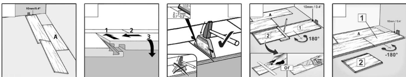
Dbajte na to, aby panely boli vždy v rovnej líni, čo je potrebné k tomu, aby sa panely spojili správne, bez medzier na dlhej strane pri pokladke druhého radu. Takto pokračujte v pokladke prvého radu.
